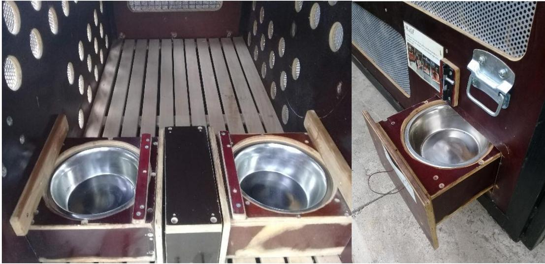
**Figura 5.** Vista de las bandejas para la provisión de agua y alimento durante el traslado, con una apertura lateral de tipo cajón.
