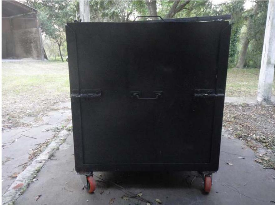
*Detalle del portón delantero, cerrado mediante dos fuertes cerrojos a los extremos.*
