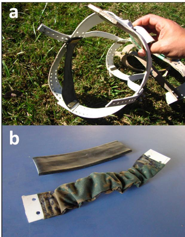
**FIGURA 3.** Ejemplos de bandas elásticas colocadas dentro del arnés para maximizar el ajuste y a la vez otorgar capacidad de expansión o retracción en caso de cambios de peso: a) prototipo original con una cámara de bicicleta, y b) Material expresamente diseñado para collares expandibles fabricada por Telonics Inc.
