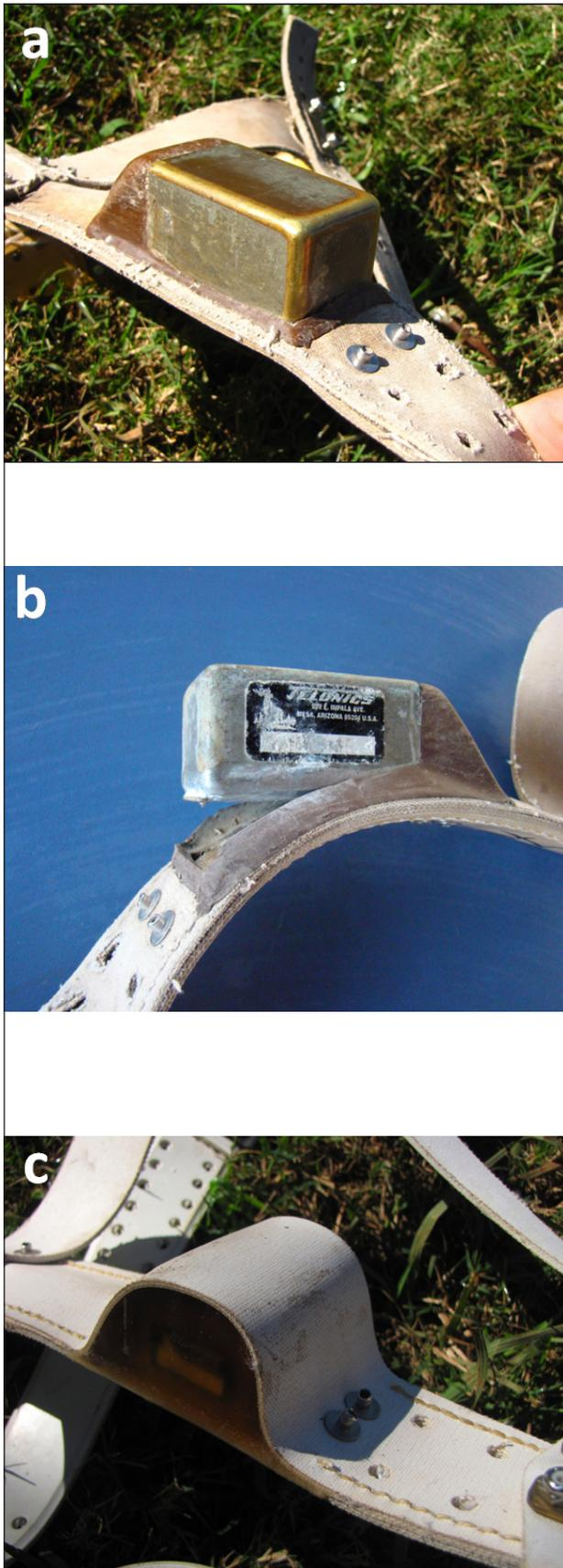
**FIGURA 2.** Ejemplos de cajas de protección del radiotransmisor ubicadas sobre la correa dorsal del arnés: a) modelo original de caja de forma rectangular, b) ejemplo de cómo este modelo puede acabar separándose del arnés con el uso, y c) modelo mejorado de caja transmisora cubierto con epoxi y con una banda extra de butilo.
